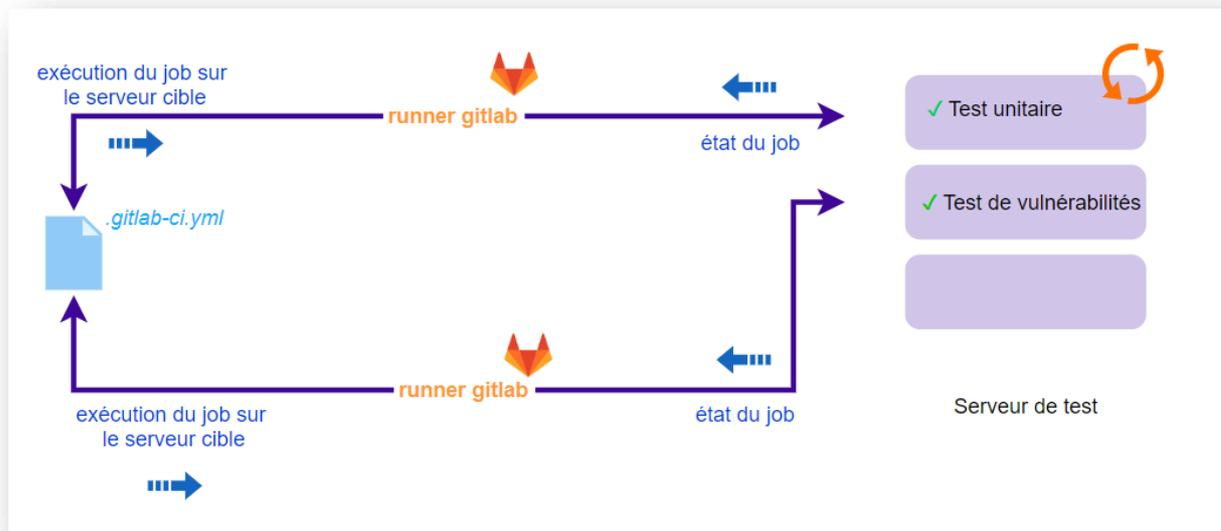
Les pipelines GitLab CI/CD sont configurés à l'aide d'un fichier YAML appelé *".gitlab-ci.yml"* dans chaque projet. Ce fichier est exécuté lors de chaque commit et définit la structure et l'ordre des pipelines et détermine :
