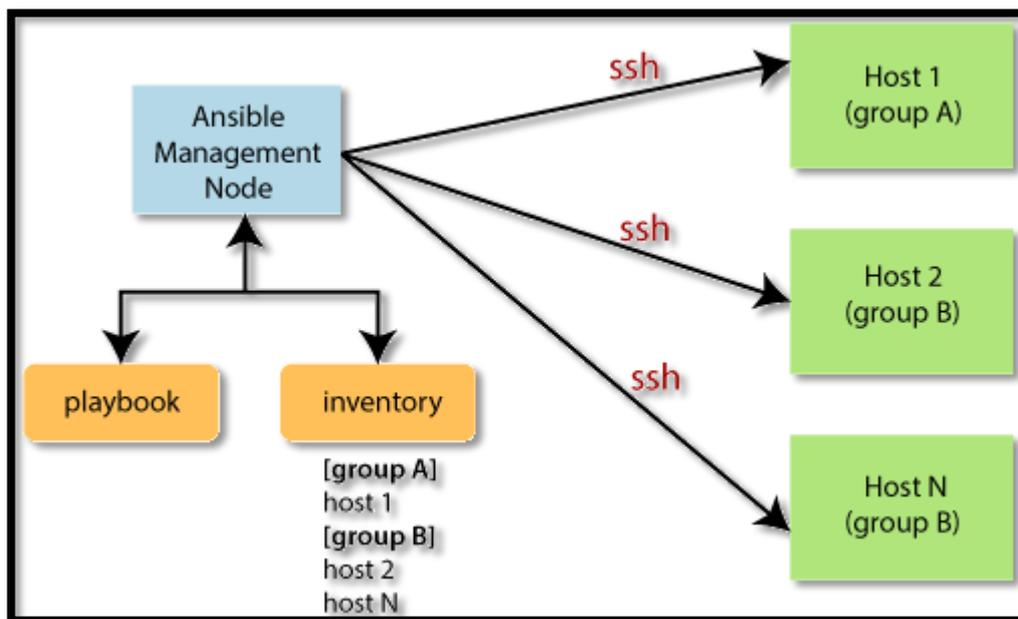
Dans Ansible, il existe deux classes de serveurs : le nœud maître (master) et les nœuds esclaves (slaves). Le nœud maître est une machine sur laquelle est installé l'outil Ansible et les nœuds esclaves sont les machines cibles sur lesquelles le nœud maître ordonne l'exécution de tâches Ansible.
